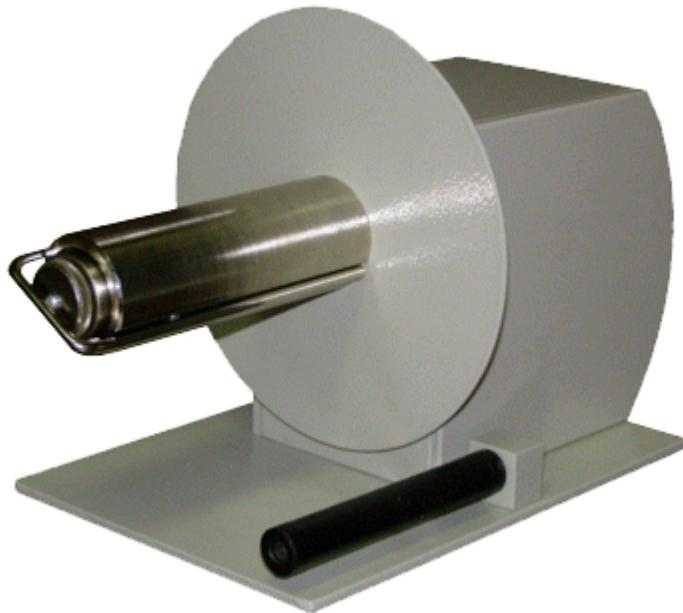
Pohon navíjecího trnu zajišťuje elektromotor přes kluznou spojku se seřiditelným tahem. Motor je napájen z vnějšího síťového adaptéru, který je součástí dodávky navíječe etiket. Navíječ má robustní konstrukci. Téměř všechny díly jsou kovové, což zajišťuje dlouhou životnost a zároveň dobrou stabilitu na pracovním místě.
